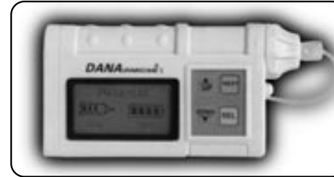
Şekil 5.3: Açık devre modeli insülin pompası
